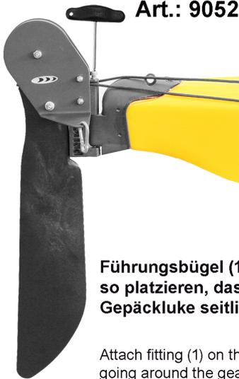
Führungsbügel (1) bei Bedarf im Heckbereich des Bootes so platzieren, dass die Aufhol-Leine auf Deck um die Gepäckkluke seitlich herum geführt wird.
