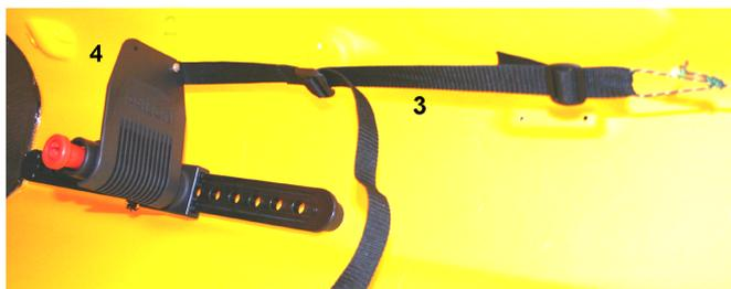
Verstellgurte der Steuerleinen (3) mit Schrauben an den Pedalen (4) befestigen und diese dann in mittlere Position bringen. Der Verstellgurt sollte in mittlerer Position sein. Anschließend die Steuerleinen durch die Leinenführungen zum Bootsheck durchschieben. Steuer in Mittelposition bringen, Steuerleinen durch die Karabiner stecken und so vorspannen, daß die Pedale ca. senkrecht stehen, dann die Steuerleine mit dem Karabiner verknoten. Lose Enden abschneiden.
